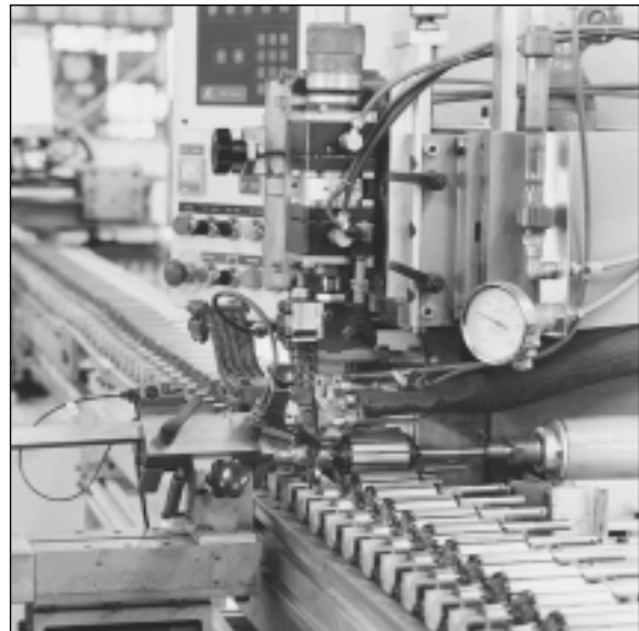
Ligne automatique - Soudure collecteur MBT65
