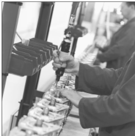
Poste de montage motoréducteurs
