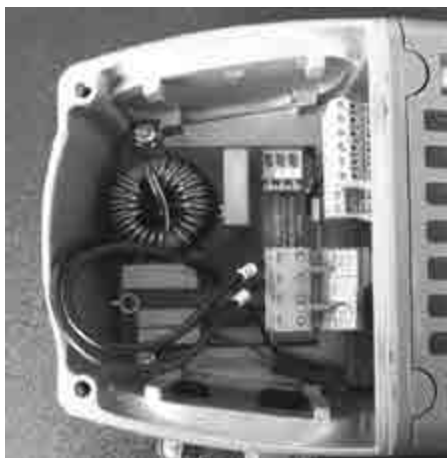
Interner Filter FLT VMA31M/32M 110 für Wechselstromserie
