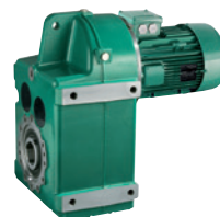
Manubloc 3000 jusqu'à 14 500 Nm Sortie parallèle à arbre plein, arbre creux ou arbre creux avec frette de serrage Montage à bride ou avec bras de réaction
