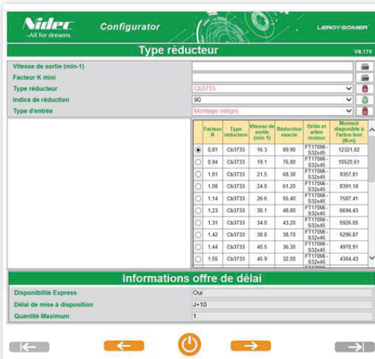
Sélection du réducteur liée à la sélection du moteur
