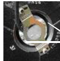
Codeur Danaher (2 vis cruciformes)
