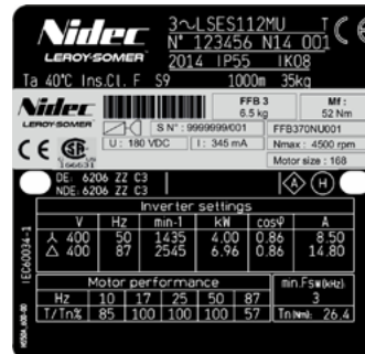
Leistungsschild Bremsmotor mit Umrichter LSES112MU 4 kW, 4p, 400 V λ
