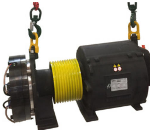
Рис. 3: Подъем двигателя (исключительно в иллюстративных целях)
