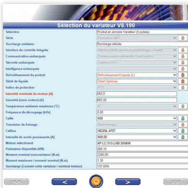
Sélection du variateur liée à la sélection du moteur
