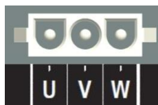
Figure 1 : Connexion détection de tension alternateur
