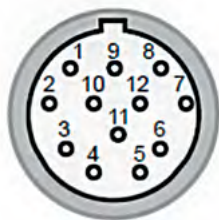
Sicht auf den Sockel der Steckbuchse M23 (Gegen-Uhrzeigersinn) Anwenderseite
