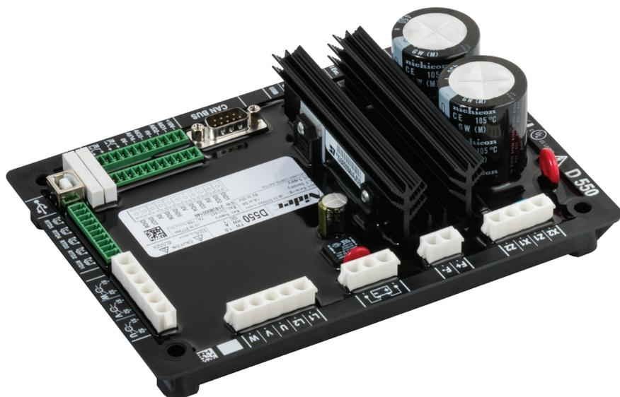
Der D550 ist ein digitaler, automatischer Generatorregler für Generatoren mit einem Nennererregstrom bis 8 A bei 55°C.
