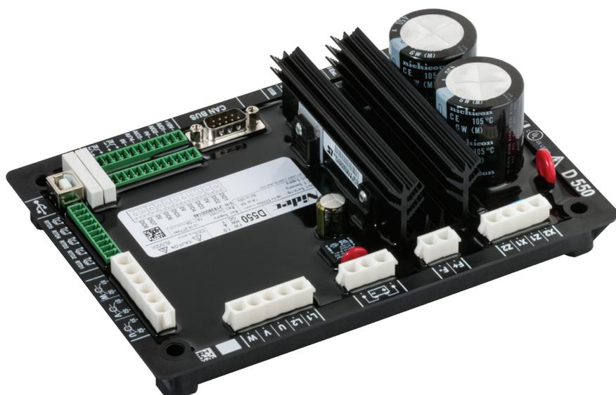
Le D550 est un régulateur de tension numérique automatique pour alternateurs avec intensité de champ nominale allant jusqu'à 8 A à 55°C.
