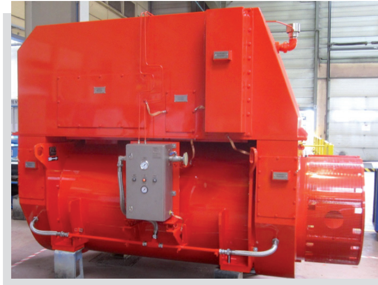
Machine Hydro-réfrigérée pressurisée pour utilisation en exploitation pétrolière offshore en environnement à risque
