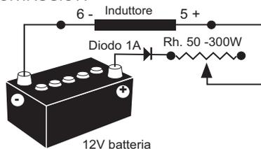
**Montaggio B:** Collegare un'alimentazione variabile «Variac» e un ponte di diodi sui 2 conduttori dell'induttore (5+) e (6-).
