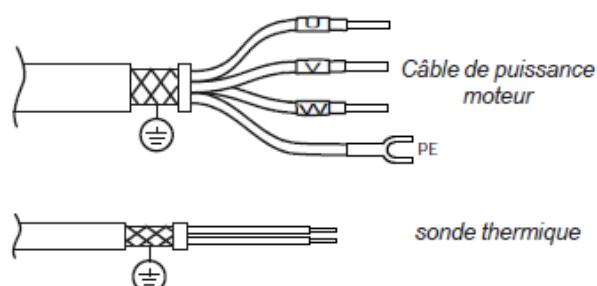
Connecter le moteur au moyen de câbles de section adéquate (les câbles et les cosses seront dimensionnées en fonction de l'intensité : voir tableau ci-après).
