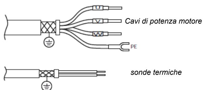
Collegare il motore usando cavi della corretta sezione (i cavi devono essere adeguati alla corrente, vedere tabella sottostante).
