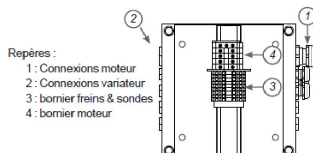
Un schéma de raccordement détaillé est présent dans le capot de la boîte à bornes.
