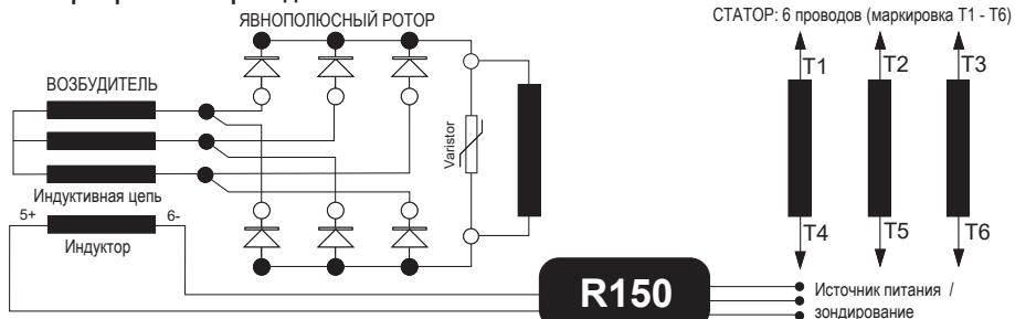
**• AREP+ трехфазный 6 проводов**
