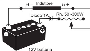
**Montaggio B:** Collegare un'alimentazione variabile «Variac» e un ponte di diodi sui 2 conduttori dell'induttore (5+) e (6-). Questi due sistemi devono avere caratteristiche compatibili con la potenza d'eccitazione della macchina (vedere la targa d'identificazione).
