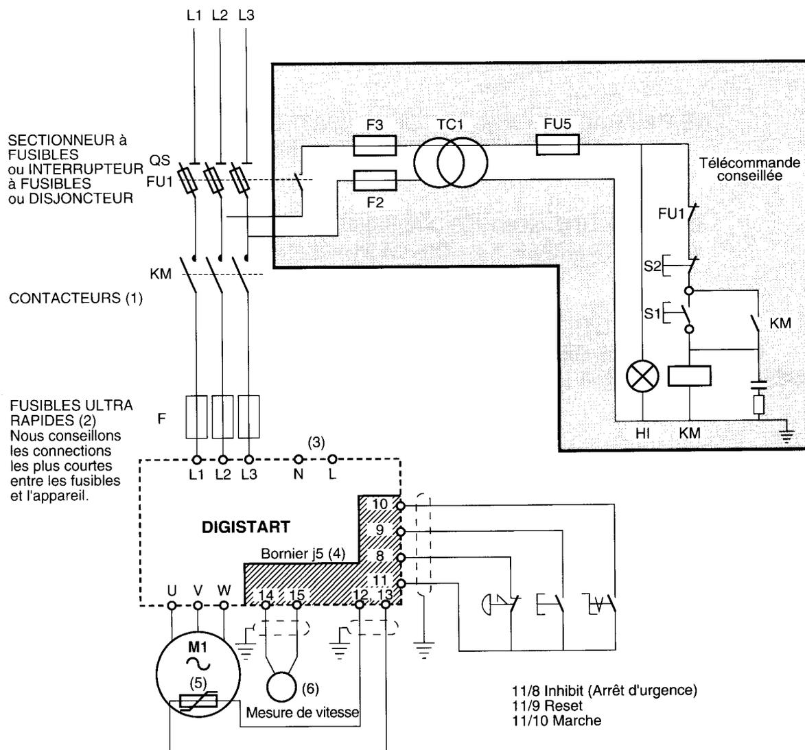
(1) Il est préférable que le contacteur KM reste en permanence fermé (sauf arrêt d'urgence éventuellement). La commande du moteur s'effectue par le bouton marche/arrêt raccordé sur le bornier J5.
