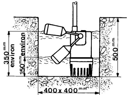
L'étanchéité du raccord de refoulement sera réalisée simplement par la compression du clapet anti-retour qui est à l'intérieur du manchon de refoulement.
