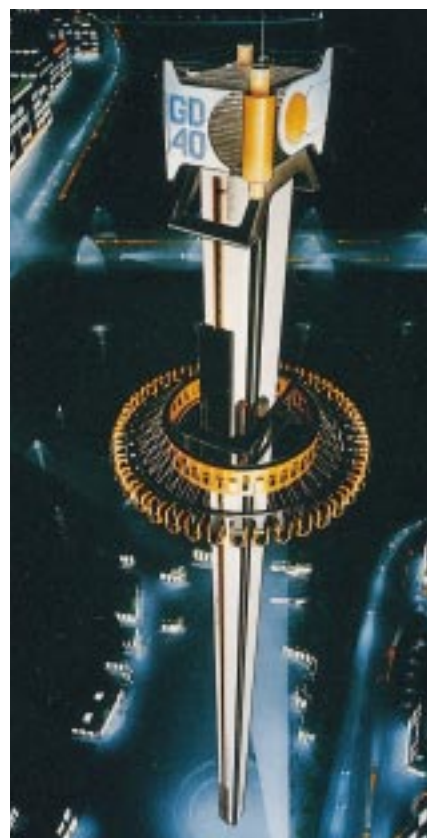
GYRO DROP equipaggiato di due motori a C.C. LSK 2804 CL - 450 kW.
