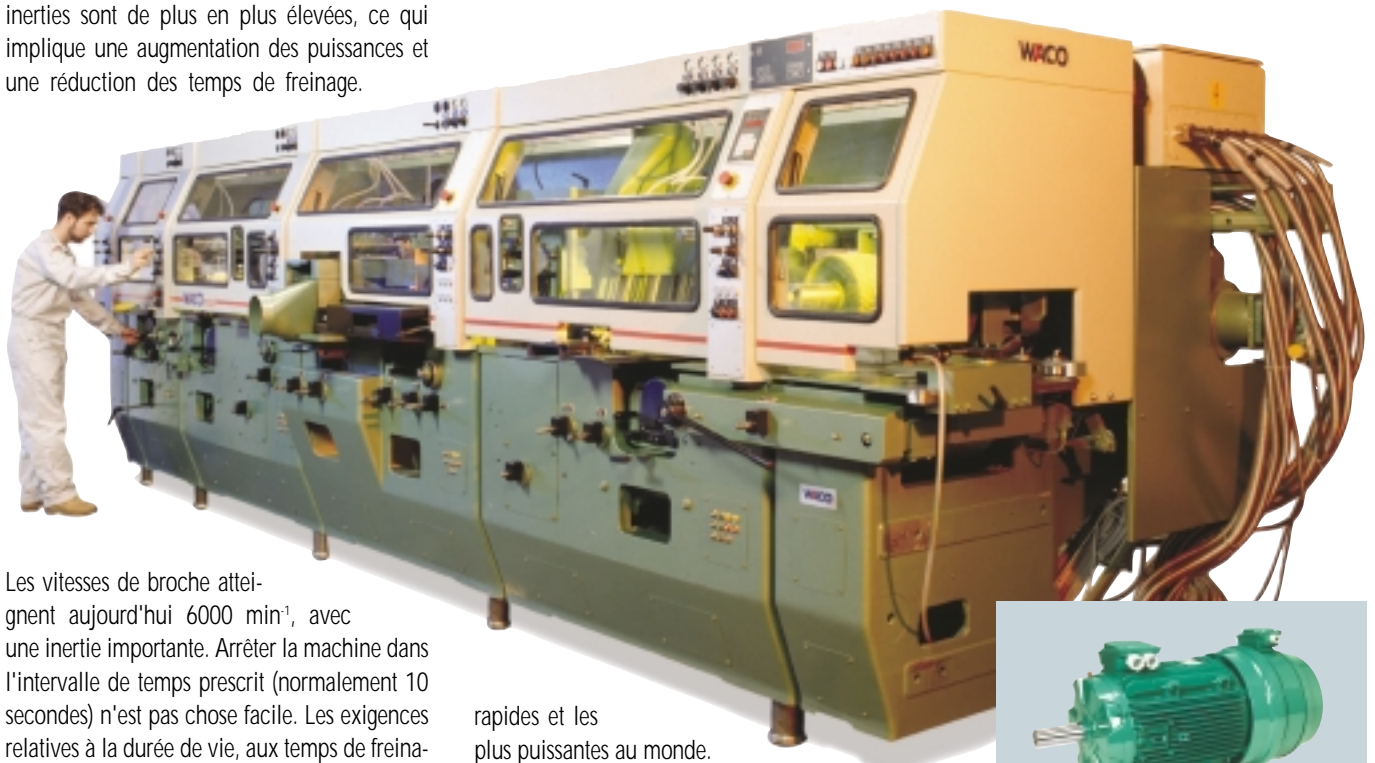
Le moteur frein Leroy-Somer FCPL utilisé pour l'entraînement des broches.
