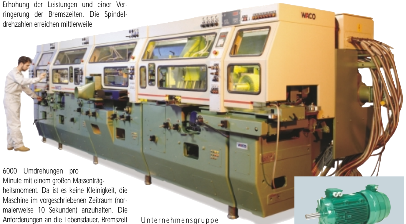
Leroy-Somer Bremsmotor FCPL zum Antrieb der Spindeln.
