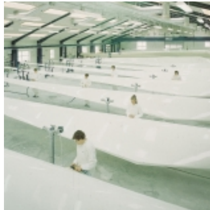
Fabricatie van de schroefbladen
