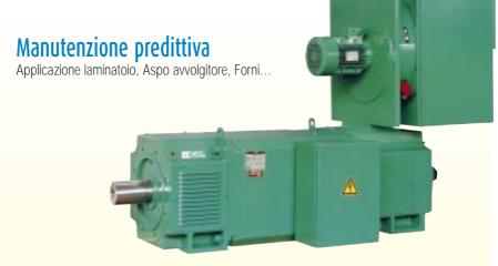
Motore a corrente continua LSK 355 40Vcc 750kw Sonde PT100 cuscinetti Sonde PT100 avvolgimenti principali Sonde PT100 avvolgimenti ausiliari Detettore flusso d'aria DT o Encoder, Detettore usura spazzole. Il motore viene controllato in permanenza. Se viene superata la soglia d'allarme avverte l'operatore per fare l'intervento prima della rottura.
