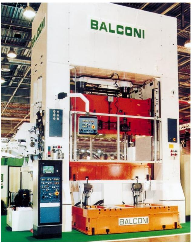
Nella fotografia è rappresentata una pressa modello 2DMRF-8-400, con una potenza sviluppata di 400 tonnellate, indicata per lo stampaggio in automatico, con l'uso di stampi progressivi di grandi dimensioni e di stampi trasferizzati.
