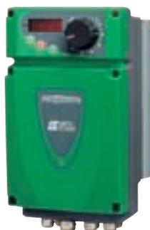
PROXIDRIVE, der neue Frequenzumrichter von Leroy-Somer wurde speziell für den Betrieb in der Nähe des Motors konzipiert, in offenem oder geschlossenem Regelkreis bei schwierigsten Umgebungsbedingungen, denen er dank seiner robusten Ausführung und **der verstärkten Schutzart IP 66 standhält. Da er keinen Schaltschrank benötigt**, umgeht er EMV-relevante Störeinflüsse und löst thermische Probleme. Funktional betrachtet bietet er zwölf voreingestellte Konfigurationen für die gängigsten Anwendungen.
