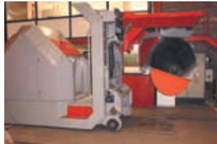
En novembre 2002, les ingénieurs de Control Techniques ont réalisé l'ensemble des systèmes d'entraînement nécessaires au pilotage d'une scie assurant toutes les fonctions de découpe dans une machine destinée à la fabrication de très grandes poutres en béton armé dont la longueur peut atteindre 120 m.
