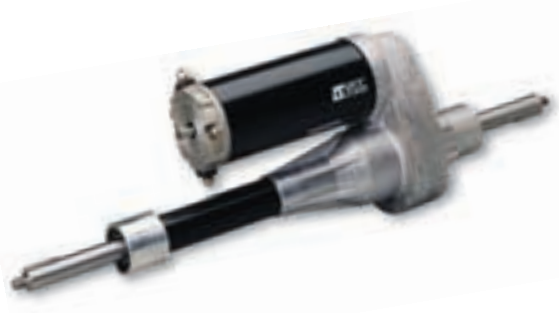
GW04 er en transaksel med en udveksling på 26,63. Drivmotoren er en MBT 82 på 150 watt, der har et omdrejningstal på 3000 o/min ved 24VDC.
