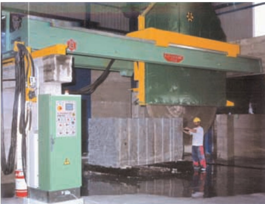
CO4B com disco de corte accionado por Ot28 directo ao veio principal
