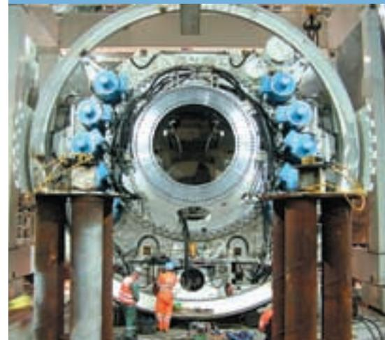
La machine à forer les tunnels mise en œuvre à Bodio ( machine de 400m, avec un poids de 120 tonnes et une tête foreuse de  $\varnothing$ 8,63m). La vitesse d'avancement de cette machine est d'environ 20m par jour.
