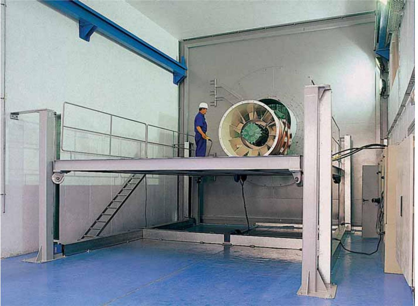
Con este sistema se pueden obtener **todas las características aerodinámicas y mecánicas de funcionamiento a plena carga de ventiladores de más de 1.000 Kw.** de potencia en apenas media hora de ensayo.
