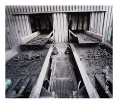
folgenden Siebvorgängen sind die Metallstücke aussortiert und können von darauf spezialisierten Unternehmen recycelt werden. Die mineralischen Rückstände werden schrittweise gereinigt. Anschließend wird die Schlacke in Verarbeitungszentren geschickt, in denen sie analysiert und zerkleinert wird, bevor sie eine neue Karriere macht, beispielsweise als Schottermaterial.
