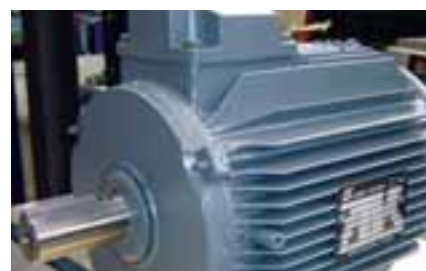
Motor niveau 4 met volledig in de kunstharz ingegoten wikkeling
