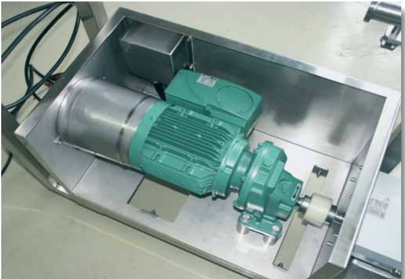
System zum Zuführen von Pulver und der Homogenisation für die Zäpfchenherstellung für die pharmazeutische Industrie.
