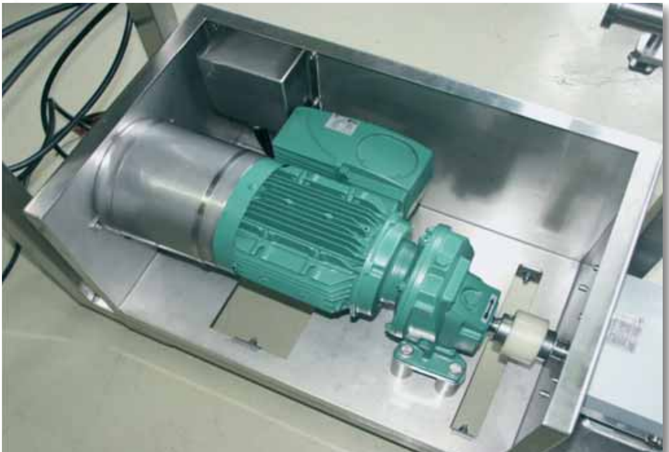
Système d'introduction de poudre et d'homogénéisation pour la fabrication de suppositoires pour l'industrie pharmaceutique
