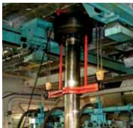
Double Jib E/R kran i funktion. Maskinrumskranens konstruktion gør, at stempel og andre komponenter kan løftes højt samt tiltes under service og reparation. Det betyder, at kravet til løftshøjde i maskinrummet kan reduceres ganske betydeligt.
