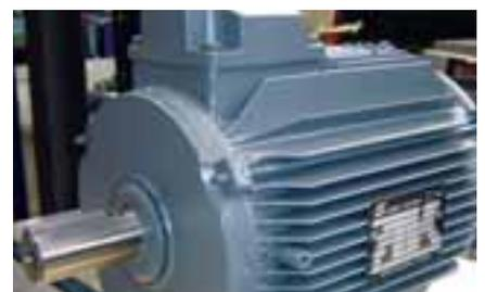
Moteur de niveau 4 à technologie enrobée
