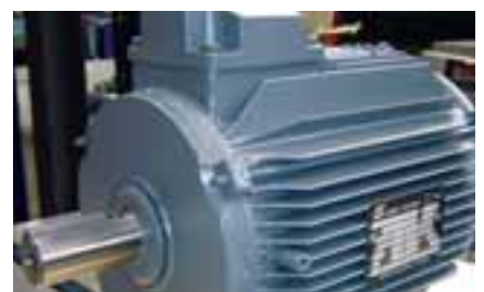
Motor niveau 4 met volledig in de kunstharz ingegoten wikkeling
