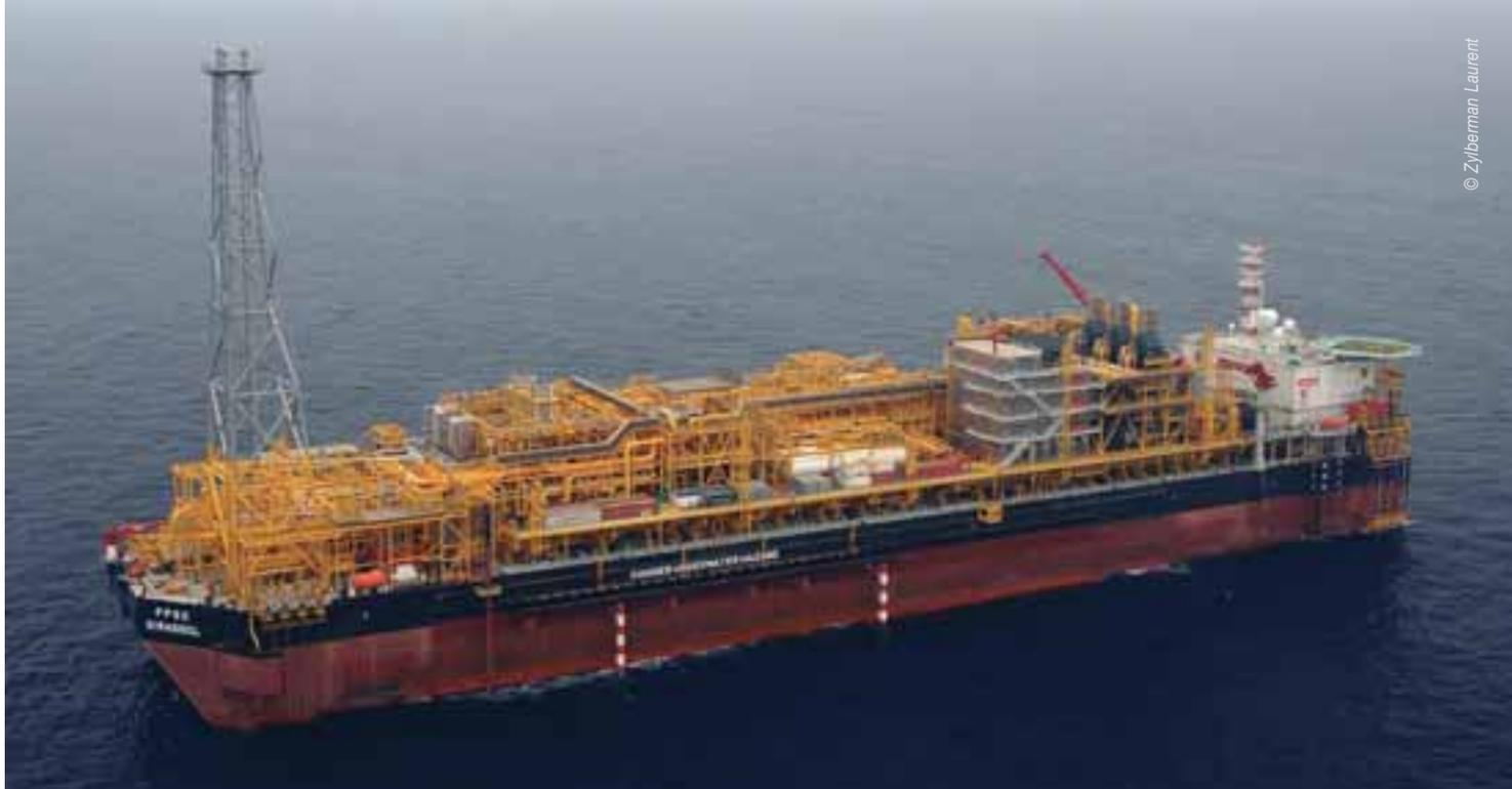
Arrivée de la plate-forme de production FPSO (Floating Production Storage and Offloading) sur le champ offshore en eaux profondes de Girassol' au large de l'Angola.
