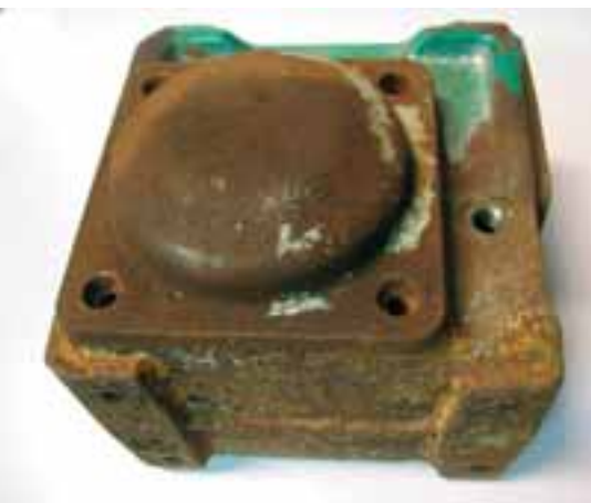
Gewone motor en reductor in een sterk agressieve omgeving.
