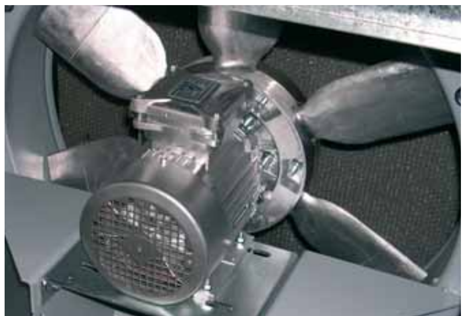
Von Leroy-Somer gelieferte Baureihe: Baureihe FLSHT Option ExII3G
