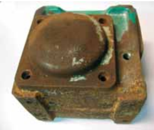
Moteur et réducteur courants dans un environnement agroalimentaire fortement agressif.
