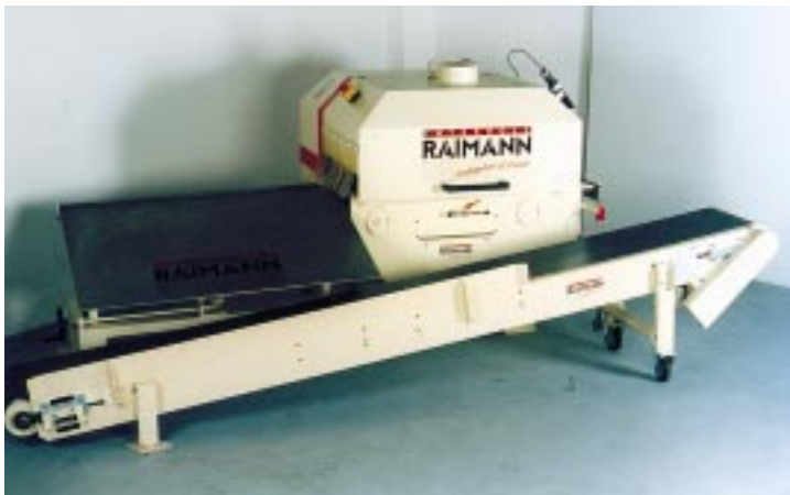
Automatische Vielblatt-Kreissäge KS 310 mit Auslauf-Trenneinrichtung und angetriebenem Rücklauf-Förderband
