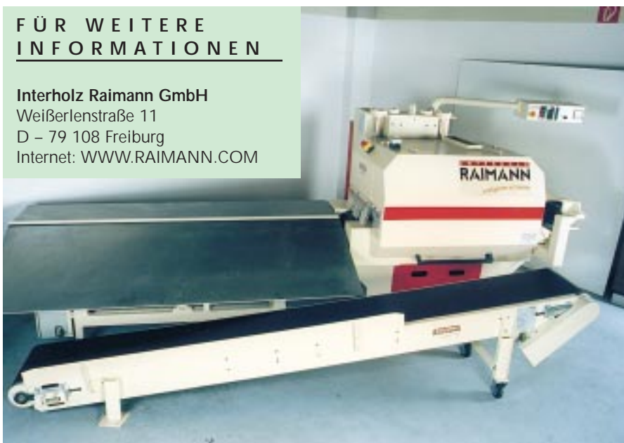
Automatische Vielblatt-Kreissäge KS 310 mit Auslauf-Trenneinrichtung und angetriebenem Rücklauf-Förderband
