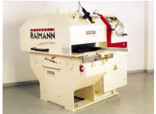
Automatische Vielblatt-Kreissäge KM 310
