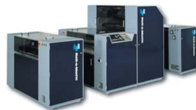
Roll-O-Matics anlæg til fremstilling af plastposer og plastfolier er forsynet med LSMV-motorer med encodere.
