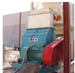
Hele processen med at udnytte energien fra trærester i biomassefabrikken i Villacañas er drevet af motorer, gearmotorer og vekselstrømsgeneratorer fra Leroy-Somer, der er godkendt til atmosfærer med eksplosionsfarligt støv (ATEX støv).
