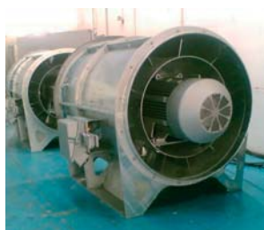
Undergrundsbanerne i Rom, Istanbul og Kiev er udstyret med ventilatorer fra Zitron, der drives af højtemperaturmotorer fra LS. De to nye tunneller på A86 (Frankrig), der blev færdige i 2006, er udstyret med 200 aksial- og stråleventilatorer, som drives af LS-motorer med et eller flere gear på mellem 9 kW og 560 kW.
