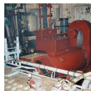
Esperanza er forsynet med en 1.300 kVA LSAM52.2-generator, som forsyner de elektriske fremdrivningsmotorer. Kabelsystemet om bord er forsynet med en 450 kVA akselgenerator af typen LSAM50.1M6. To frekvensomformere af typen UMW3301-600T sikrer reguleringen af fremdrivningsmotorerne PLS 450LB-400kW 600rpm.
