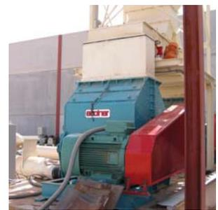
*La totalidad del proceso de valorización energética de los residuos de madera de la planta de biomasa de Villacañas está equipada con motores, motorreductores y alternadores LS certificados para poder funcionar en atmósfera explosiva (ATEX polvo).*
