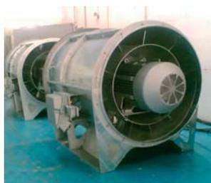
*Los metros de Roma, Estambul y Kiev están equipados con ventiladores Zitron accionados por motores LS Alta Temperatura. Los dos nuevos túneles de la autopista A86 (Francia), terminados en 2006, están equipados con 200 motoventiladores axiales y jet fan, motorizados por la gama LS de una y varias velocidades entre 9 kW y 560 kW.*
