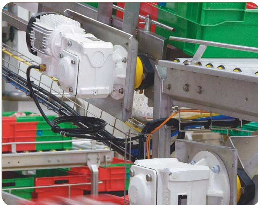
Desde que aparecieron los variadores tipo "convertidores de frecuencia", los motores asíncronos ya no son simples mecánicas sometidas a las incertidumbres de las caídas de tensión. Si están bien pilotados, los variadores permiten adaptar en cada instante la velocidad de los motores a las necesidades de la aplicación que accionan, sea desplazar un objeto a una velocidad dada o regular el caudal o la presión de un fluido.
