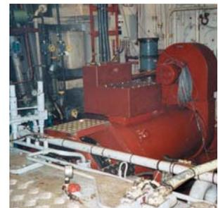
*El Esperanza está equipado con un alternador LSAM52.2 de 1300 kVA que alimenta los motores de propulsión diesel-eléctricos. La red de a bordo dispone de un alternador de cola LSAM50.1M6 de 450 kVA. Dos variadores de velocidad del tipo UMV3301-600T se encargan de la regulación de los motores de propulsión PLS 450LB-400kW 600 rpm.*
