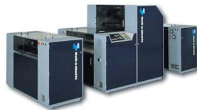
Las instalaciones de producción de bolsas y film de plástico diseñadas por Roll-O-Matic están accionadas por motores LSMV equipados con encoder.
