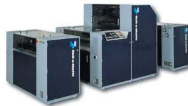
De productie-installaties van plastic zakken en plastic folie ontworpen door Roll-O-Matic worden aangedreven door LSMV motoren uitgerust met encoders.
