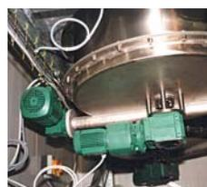
*I trasportatori Spiromatic sono dotati di motoriduttori Leroy-Somer della serie Compabloc 3000 con motori di sicurezza LSPX utilizzabili in zona 21.*
