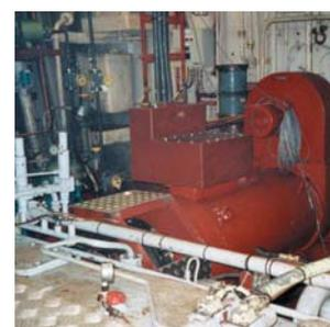
*L'Esperanza è dotata di un alternatore LSAM52.2 da 1300 kVA che alimenta i motori di propulsione elettrica. La rete di bordo è munita di un alternatori di linea d'albero LSAM50.1M6 da 450 kVA. Due variatori di velocità di tipo UMV3301-600T effettuano la regolazione dei motori di propulsione PLS 450LB-400kW 600rpm.*
