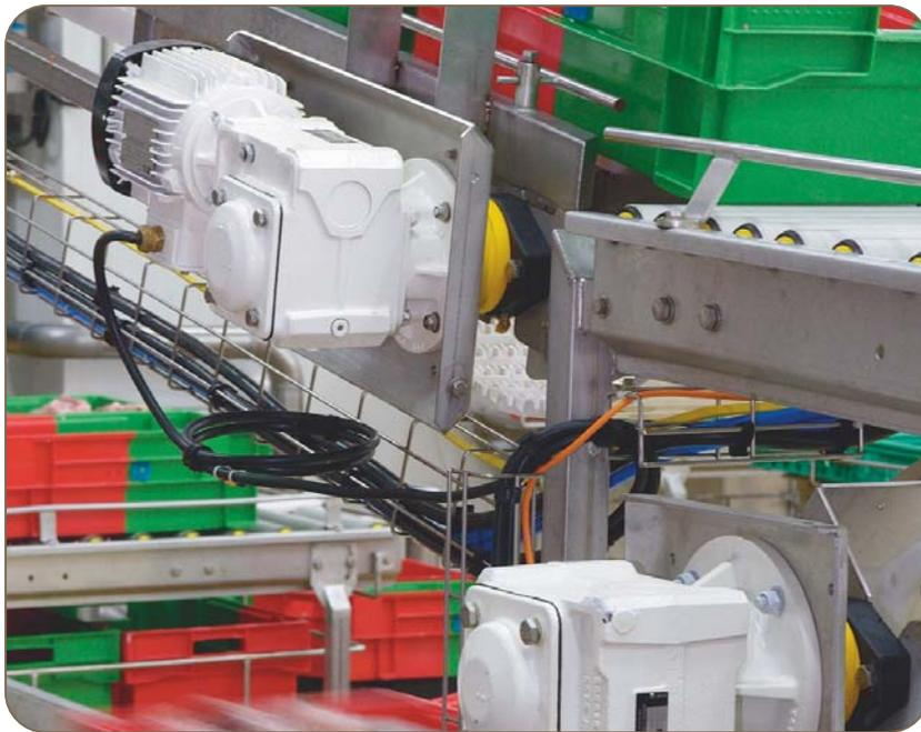
Desde o advento dos variadores do tipo «convertidores de frequência», os motores assíncronos deixaram de ser simples mecânicas sujeitas aos caprichos das quedas de tensão. Correctamente comandados, eles permitem a adaptação, momento a momento, da velocidade dos motores às necessidades da aplicação que estão a accionar, quer esta se trate de deslocar um objecto a uma dada velocidade, quer de regular o caudal ou a pressão de um fluido.
