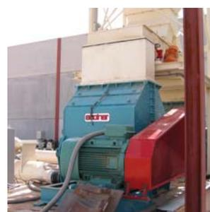
*A totalidade do processo de valorização energética dos resíduos da madeira central de biomassa de Villacañas está equipado com motores, moto-redutores e alternador LS certificados para poderem funcionar em atmosferas explosivas (ATEX poeiras).*
