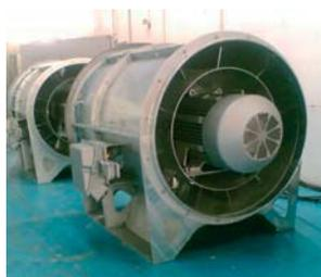
*Os metros de Roma, Istambul e Kiev estão equipados com ventiladores Zitron accionados por motores LS Alta Temperatura. Os dois novos túneis da A86 (França) concluídos em 2006, estão equipados com 200 moto-ventiladores axiais e jet fan, motorizados pela gama LS mono e multivelocidades de 9 kW a 560 kW.*
