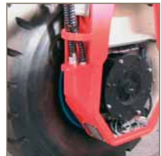
Moteur HPM Intégré dans le moyeux de roue
