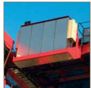
Variateur Powerdrive en armoire Inox
