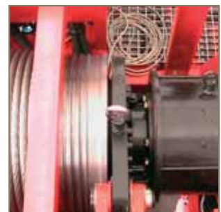
Moteur HPM Intégré dans le tambour du treuil de levage
