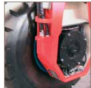
In die Radnabe integrierter HPM-Motor
