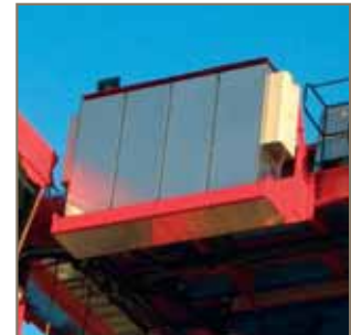
Frequenzumrichter Powerdrive in Edelstahlgehäuse
