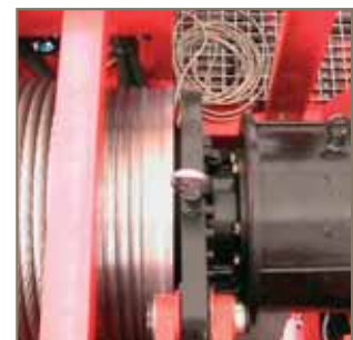
In die Windentrommel integrierter HPM-Motor
