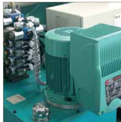
Hydraulisk aggregat, som driver pladebearbejdningmaskiner (pladebukkere til lange plader), der er udstyret med en motor med indbygget frekvensomformer af Varmeca-typen fra Leroy-Somer. Samtlige funktioner, acceleration, bremsning og de forskellige hastighedskift styres via Varmeca-frekvensomformeren, som er monteret på pumpens motor.
